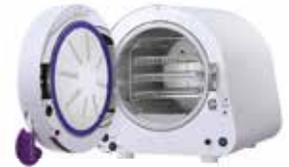
**Автоклав TANDA 18/23 – настільний автоклав на 18/23 літрів класу В з 8 температурно-часовими варіантами стерилізації при 121° і 134°C та тиском 1.1 і 2.1 Бар.**
